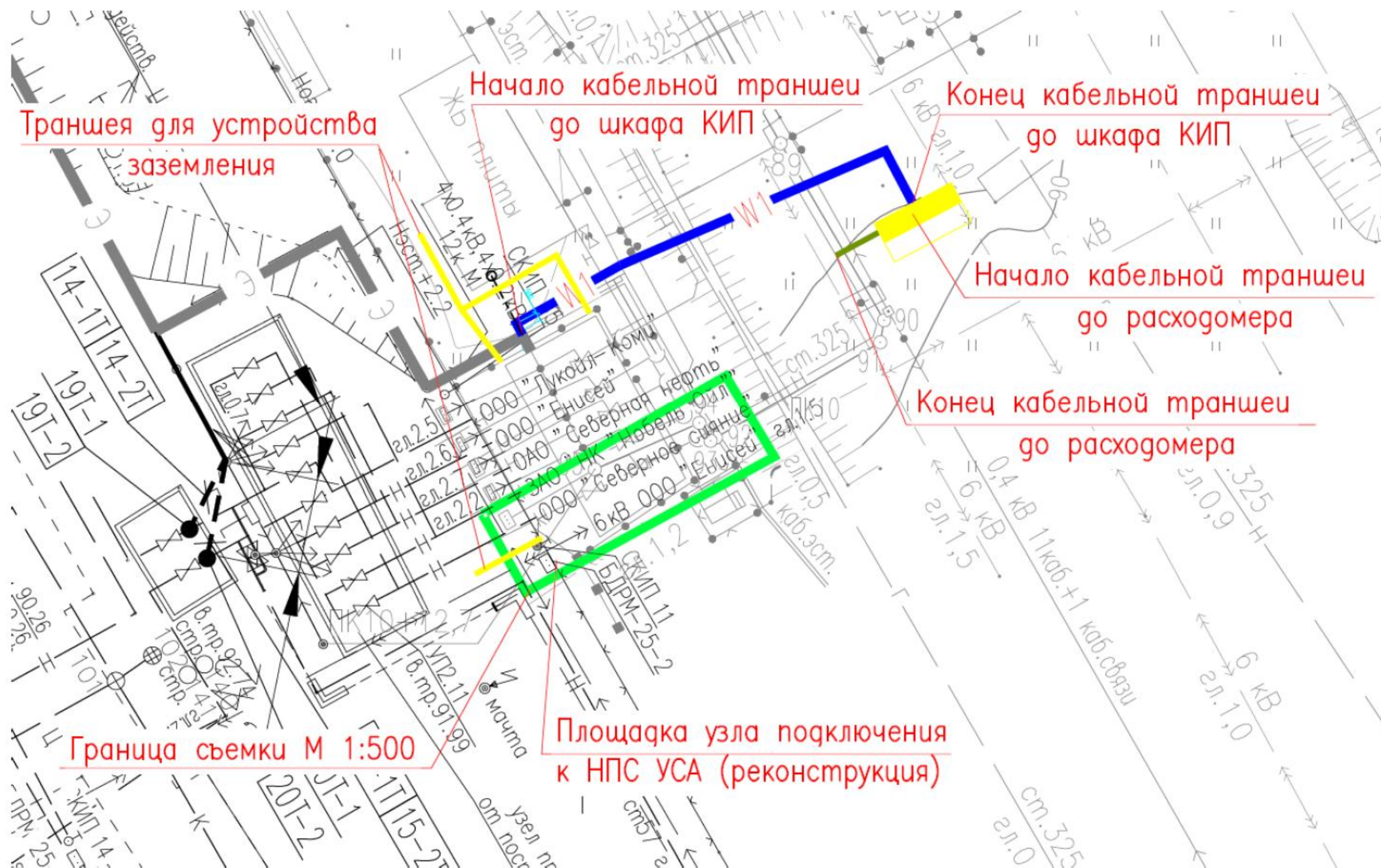
Ситуационная схема расположения площадки узла подключения и кабельных траншей на существующем подводящем трубопроводе от ПСН Головные до НПС «УСА»
