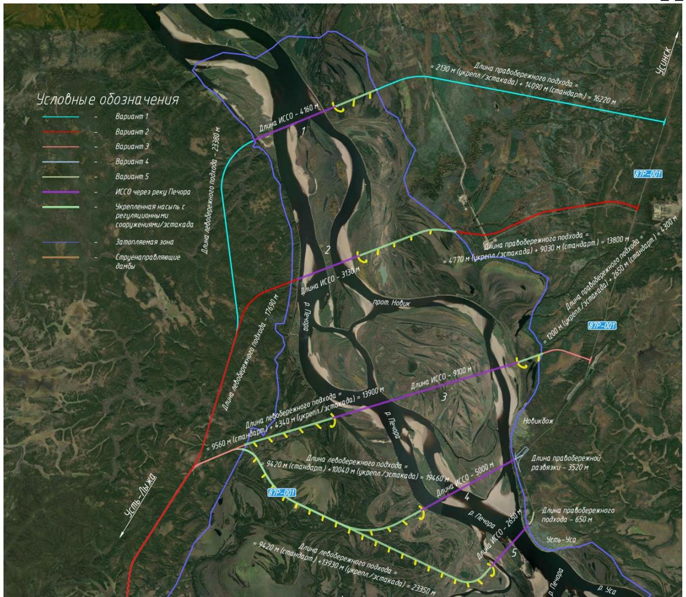
Рисунок 1. Схема вариантов прохождения автодороги и мостового перехода
