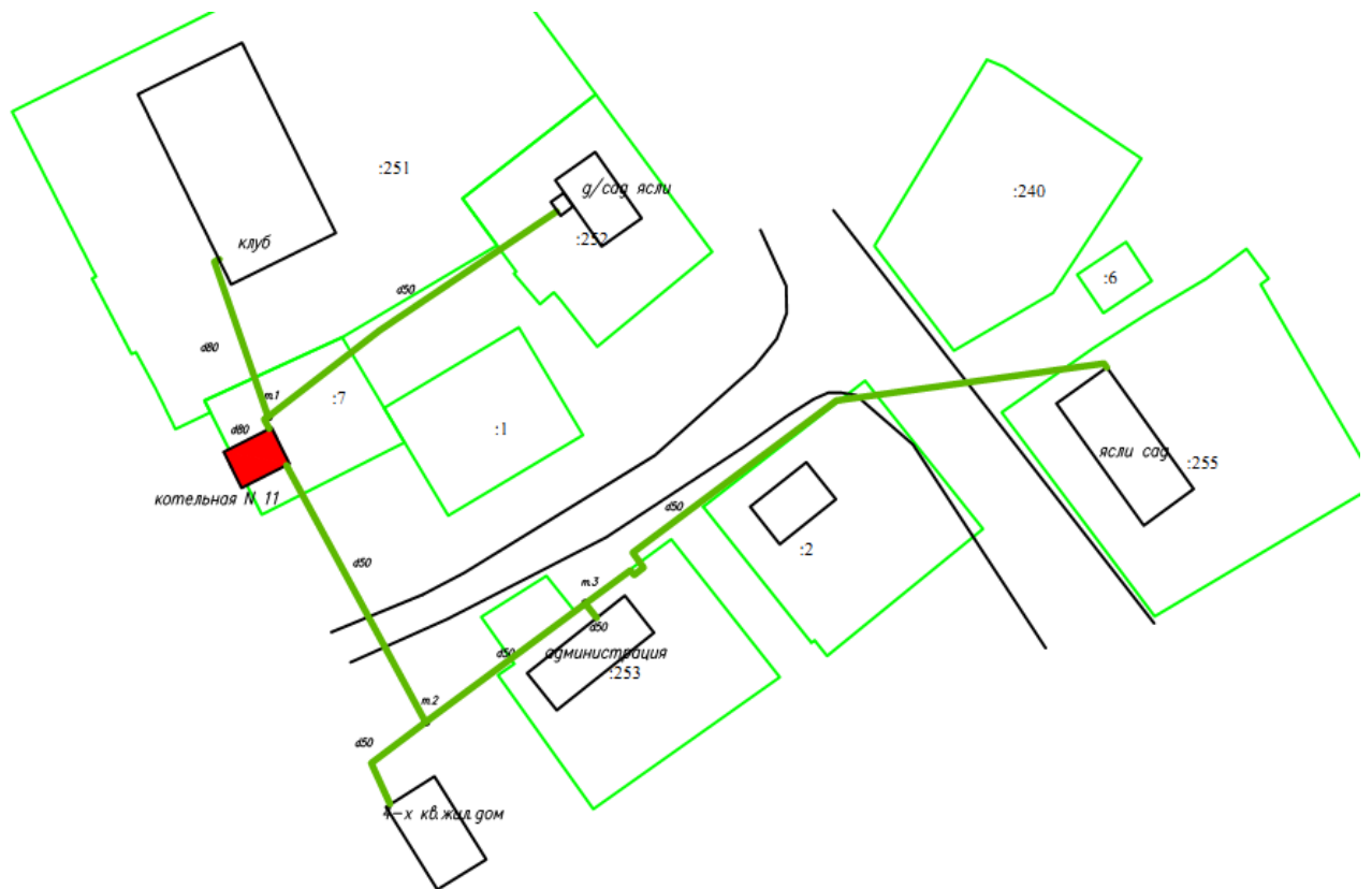
Рис.1.4.15 – Зона действия котельной №11 с. Щельябож
