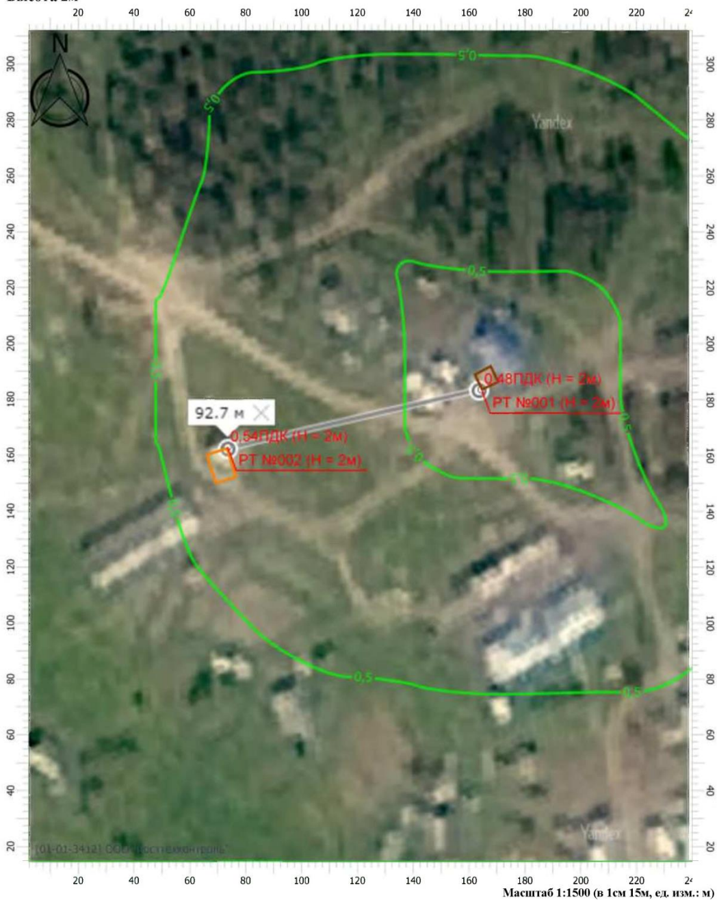
Рисунок 1.12.16 – Рассеивание вредных (загрязняющих) веществ от котельной № 19, г. Усинск, с. Мутный Материк, пер. Дорожный, 25
