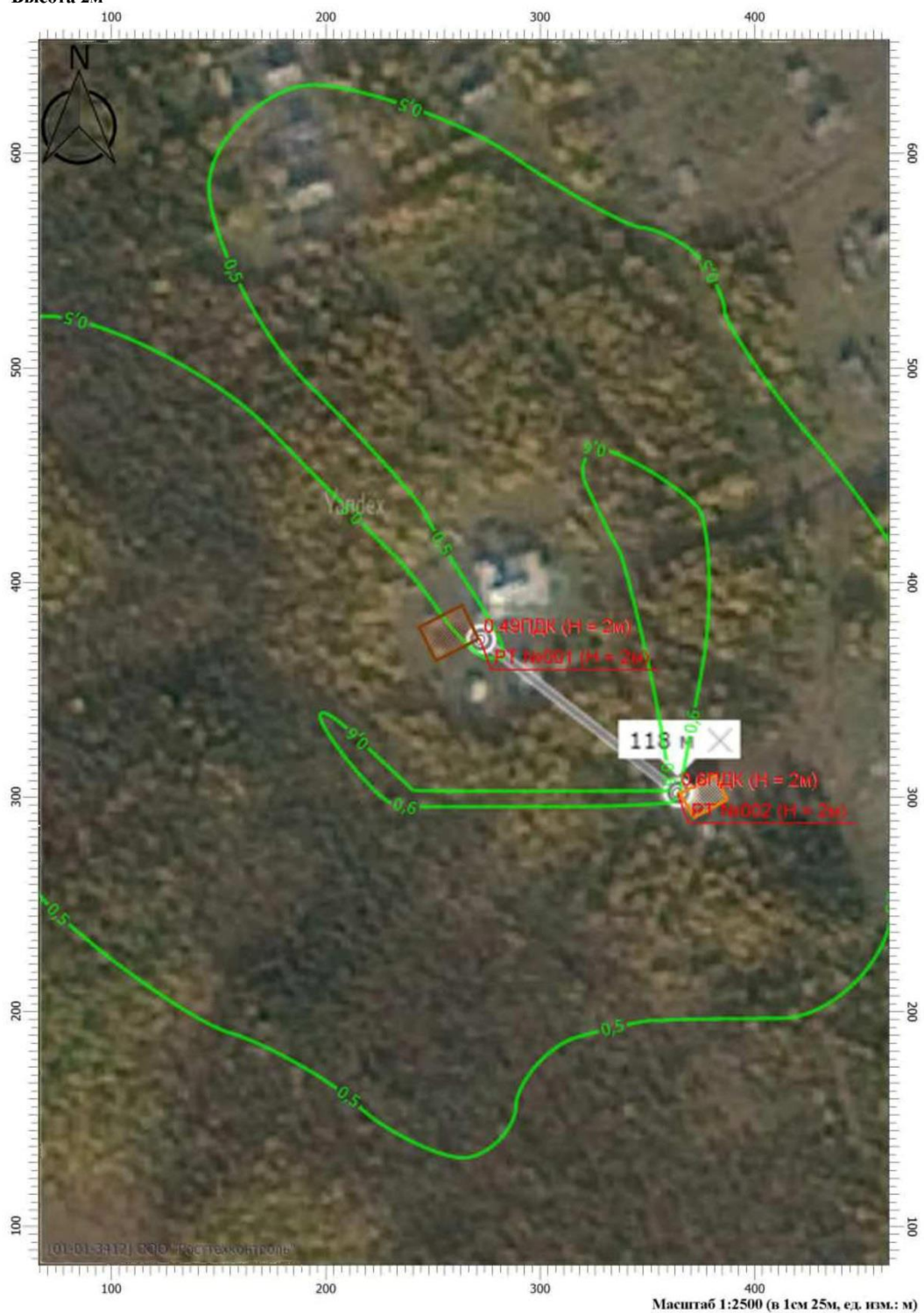
Рисунок 1.12.11 – Рассеивание вредных (загрязняющих) веществ от котельной № 13, г. Усинск, с. Щельябож, ул. Молодежная, 40
