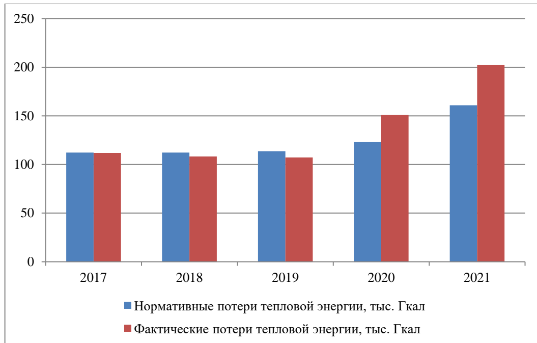
Рисунок 1.3.1 – Динамика тепловых потерь в период 2017-2021 гг. в тепловых сетях ООО «Усинская ТК»
