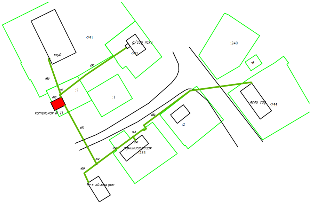
Рис.2.15 – Зона действия котельной №11 с. Щельябож
