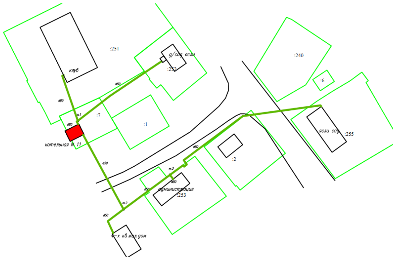
Рис.1.4.15 – Зона действия котельной №11 с. Щельябож
