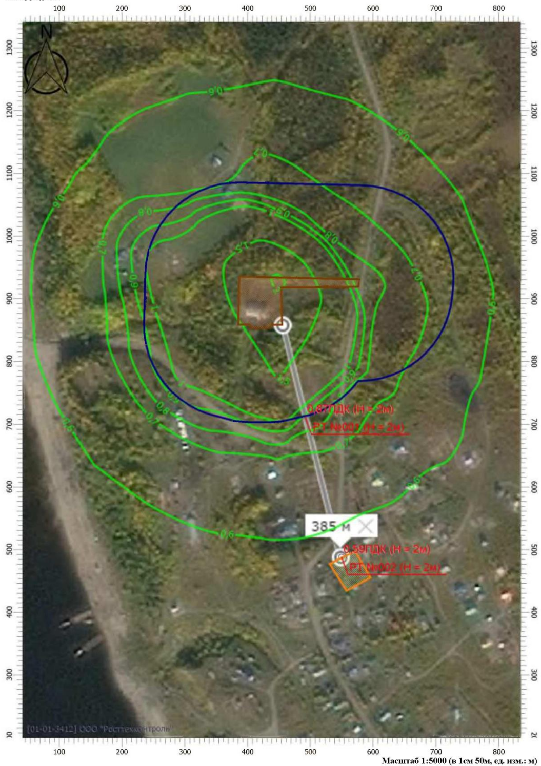
Рисунок 1.12.20 – Рассеивание вредных (загрязняющих) веществ от котельной № 24, г. Усинск, с. Усть-Уса, (располагается за пределами села)
