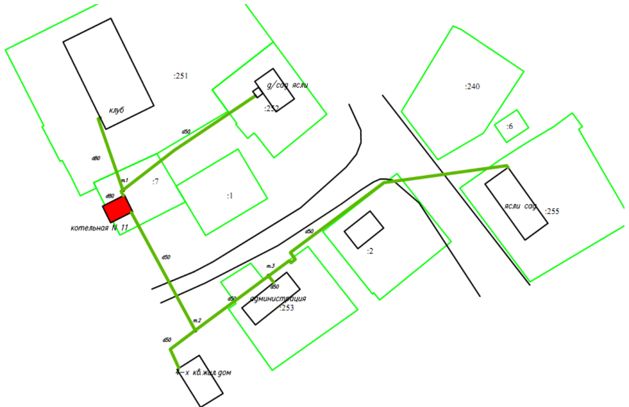
Рис.2.15 – Зона действия котельной №11 с. Щельябож
