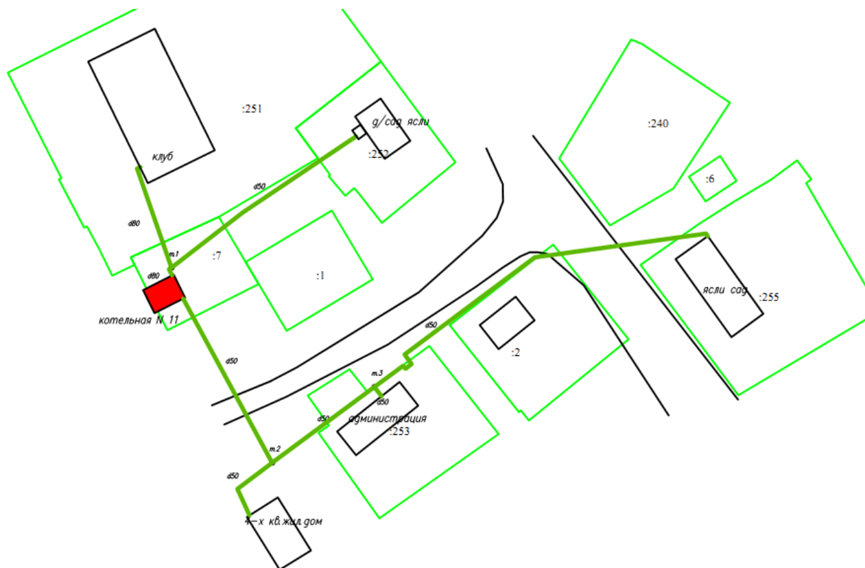
Рис.1.4.15 – Зона действия котельной №11 с. Щельябож
