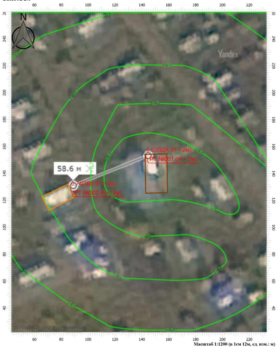
Рисунок 1.12.10 – Рассеивание вредных (загрязняющих) веществ от котельной № 11, г. Усинск, с. Щельябож, ул. Молодежная, 61
